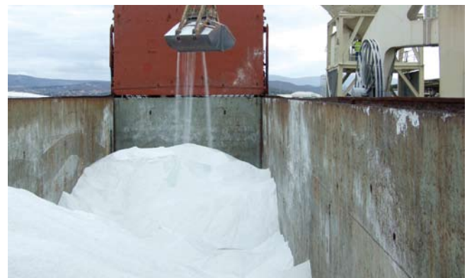
Sol raztovarjajo z ladje z grablcem in jo preko bunkerja nalagajo v kamione za skladiščenje ali na zunanje kamione za kupce
