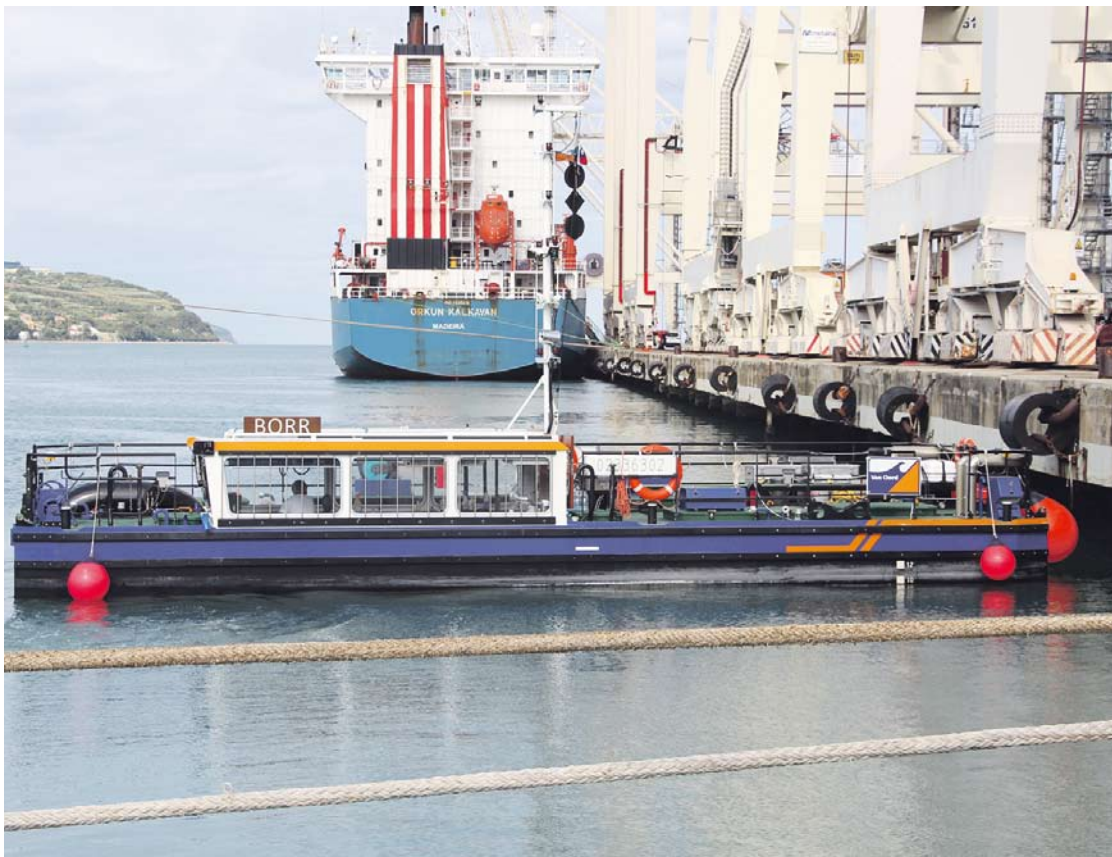
Borr pogloblja kontejnersko obalo in pripravlja teren za naslednjo fazo, ki jo bo opravil njegov »veliki brat« Dravo Costa Dorada.
