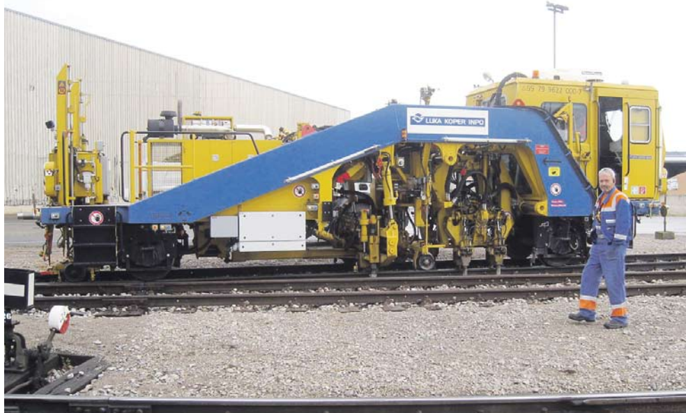
»Podbijalka« na delu - lani nabavljen nov stroj za višinsko in smerno regulacijo železniških tirov
