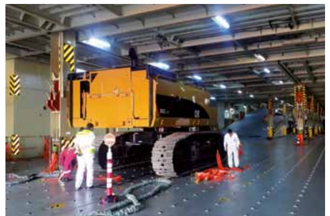
Pričvrščevanje (po luško »ricanje«) v ladijskem trupu, kjer je odpotoval v svojo novo domovino.
