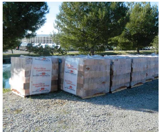
Opeka iz mešanice morskega sedimenta in laporja se že nahaja v pristanišču in bo uporabljena za gradnjo
