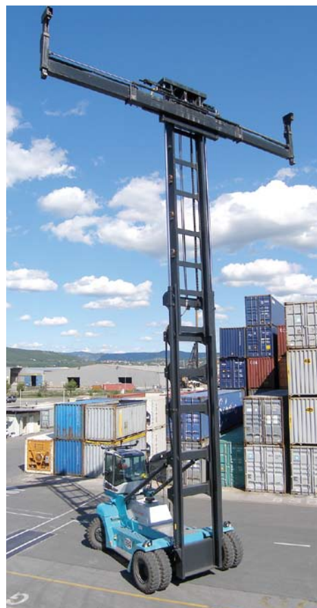
Nosilnosti kontejnerske »kamele« je 9 ton Foto: Igor Milutinovič
