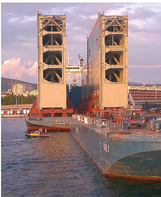
16 orjaških zapornic za panamski prekop je od proizvajalca iz pristanišča v Porto Nogaro do Trsta vlekla hčerinske družbe Luke Koper Adria-Tow, prve štiri 22. julija 2014, zadnje pa 4. oktobra istega leta. Vsaka je bila dolga 60 in visoka 40 metrov, težka pa okoli 4000 ton.
