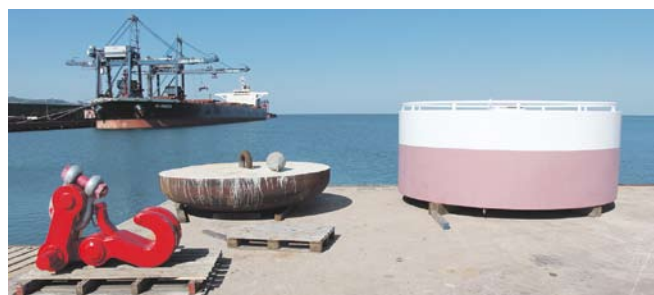
Za učinkovito delovanje sidra poskrbi posebna večtonska utež oz. sinker (na sredini), ki prepreči morebitno gibanje sidra v navpični smeri.
