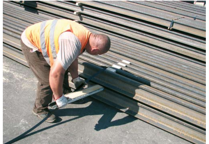
Naprava za nastavljanje lesene podloge in povezovalnega traku za vezanje tirnic v veze po pet tirnic; za nastavljanje je potreben en delavec, po prvotni zasnovi pa dva.
