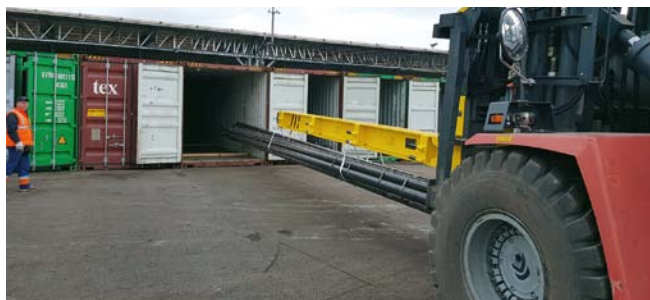
Distančni trni za zahtevno manipuliranje s tovorom velikih dimenzij, kot je zlaganje 12-metrskih cevi v kontejner.
