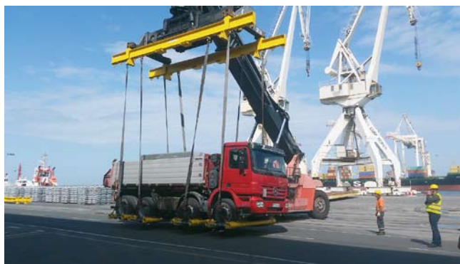
Distančni nosilec za pretovor kamionov in avtobusov, zmogljivosti 4 x 7 ton.
