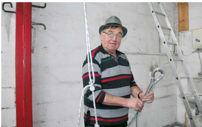
Eden od začetnih korakov je vezanje zanke na koncu zajle, da se ta ne bi takoj razpletla. Zelo pomembna je tudi priprava, najprej se vse izmeri in označi. Začetek pletenja mora biti pravilen, saj si morajo jeklene niti natančno slediti od prve do zadnje, sicer bi se zajle pod težo tovora razpletle.
