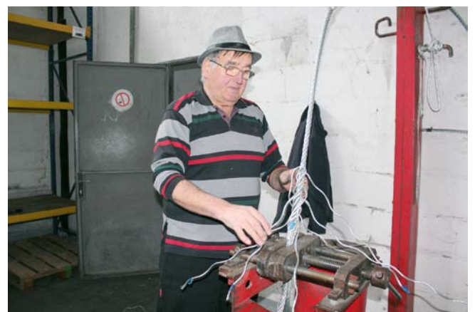
Jeklene niti je bilo potrebno v višino petkrat oviti, da se ne bi ob obremenitvi razpletle. Morajo se tudi lepo usesti, zato je Đuro vsako posebej potolkel navzdol. Zajlo je potrebno splesti še do konca vseh niti in postopek je končan. To na videz preprosto, a posebno delo, je bilo težko, zelo naporno. Veliko moči je moral imeti mož, da je lahko prepletal te jeklene niti, ki absolutno niso smele popustiti. Drugi podoben način je bilo pletenje jeklenic s ščitnikom zajle. Takšna zajla je ob pravilni uporabi trajala še več časa.
