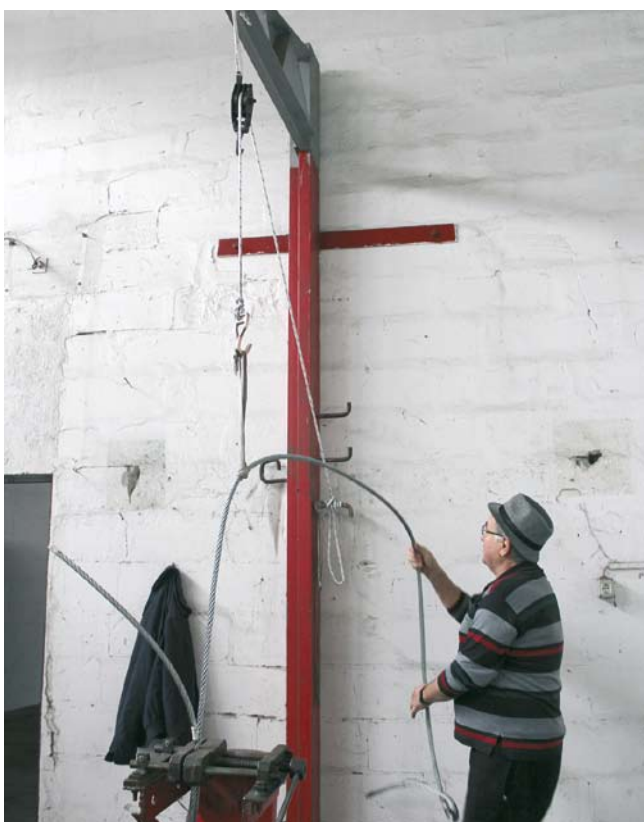
Naprava s škripcem in močnim primežem je bila odličen pripomoček za pletenje jeklenic. Nanjo so pritrdili zajlo, da so jo lahko pletli. Pri vpletanju so morali namreč z vso silo razpreti jeklene niti, da so vanje lahko potisnili dodatne niti.
