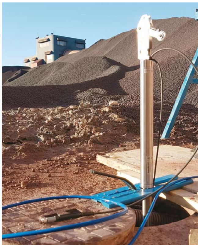
V vrtnicah ob robu deponije EET so visokokakovostne jeklene sonde, ki merijo gibanje in premike tal do 35 metrov globoko.
