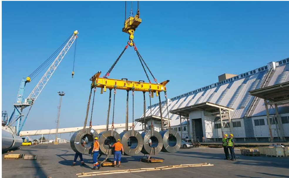
Na distančni okvir so vpeli pet zvitkov pločevine, ki tehtajo skupaj 80 ton. Za lažjo predstavlo: to pomeni enako težo, kot da bi dvignili kar 40 avtomobilov naenkrat. Foto: Sani Čejvanović
