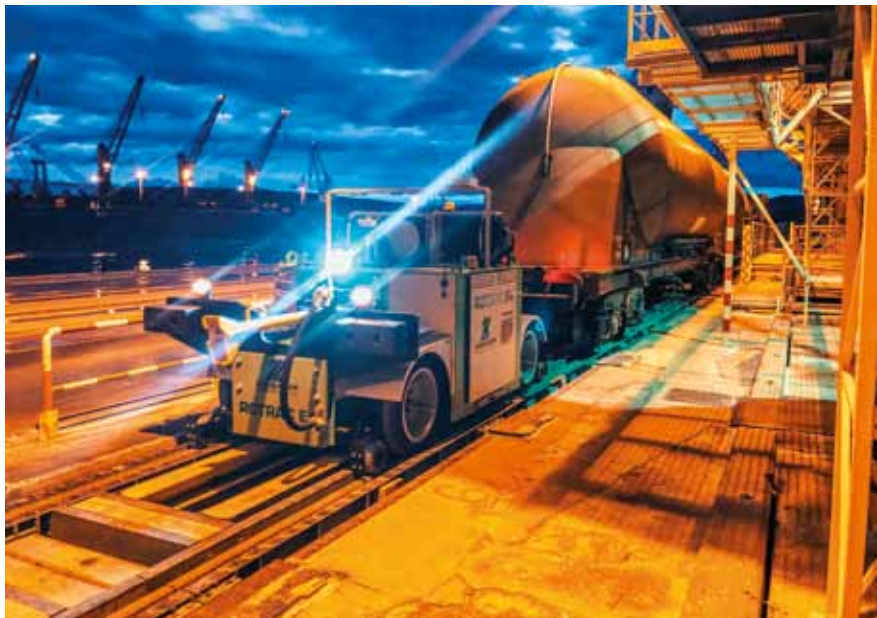
Novo električno dvopotno vozilo že premika vagonov-cistern z glinico. (foto: Kristjan Stojaković)
