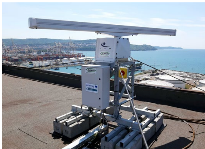
Radarski sistem za zaznavanje onesnaženja na morski gladini je nameščen na strehi našega silosa.
